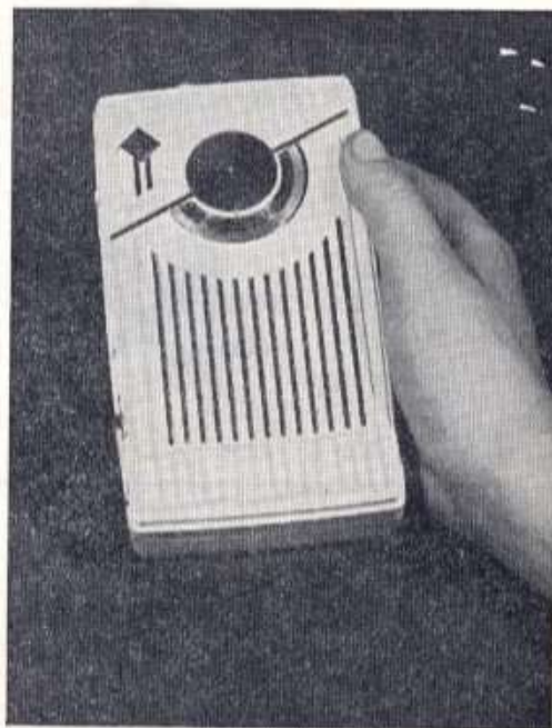
Fig. 48b Telefunken-zakontvanger, volledig met transistors uitgerust.
