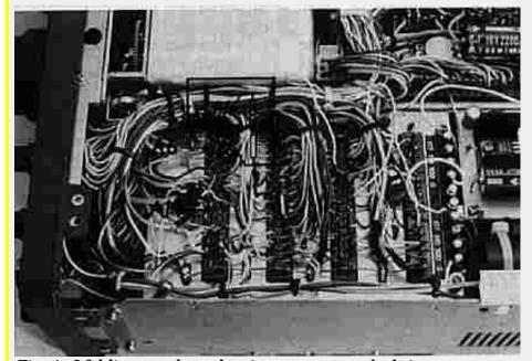
Fig 4. Lf-klippern kopplas in genom att ledningen som ar ansluten till A14 flyttas till B6. Följ sedan steg-för-stegbestrirningen beträffande nycklingen.
