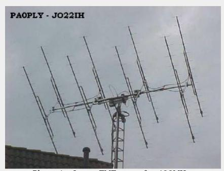
Photo 1.: Large EME array for 432MHz.
