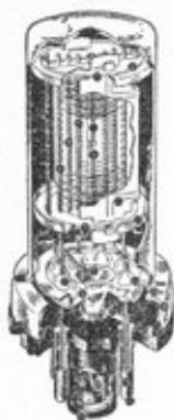
fig. 61 Amerikaanse stalen buis in doorsnee
