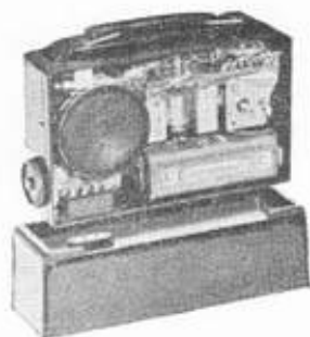
fig. 55c Braun batterij-ontvanger met onder- zetkastje waarin netvoeding afmeting ontvanger 175x120x50 mm afmeting voeding 200x60x75 mm
